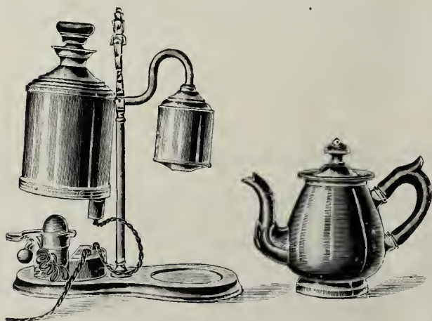
FIG. 4. — Appareil pour la préparation du café. Position de repos obtenue automatiquement.
