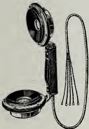
FIG. 97. — Appareil combiné Siemens et Halske avec clé.
