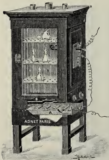
FIG. 55. — Etuve électrique système Adnet.
