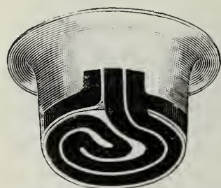
Fig. 23. — Vase intérieur montrant la disposition des résistances, système Prometheus .
