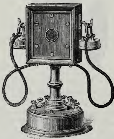
FIG. 73. — Transmetteur Roulez, modèle portatif.
