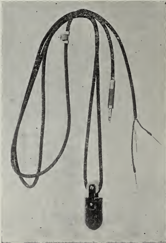
FIG. 202. — Fiche et cordon du multiple d'Adhémar.
