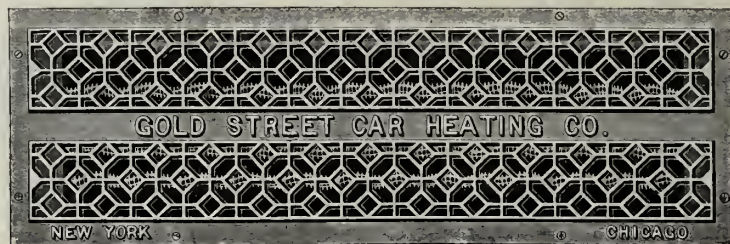
FIG. 7. — Radiateur de tramway de la Gold Car Heating Co.
