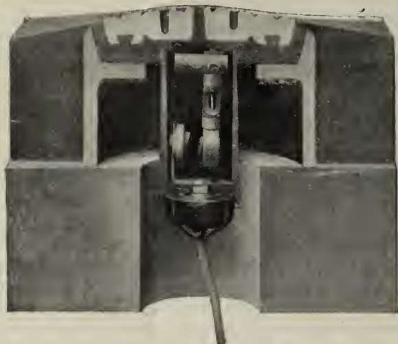
FIG. 23. — Contact superficiel, système Dolter.
