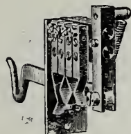
FIG. 92. — Crochet-commutateur du transmetteur Siemens et Halske.
