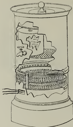
FIG. 47. — Calorifère système Le Roy.
