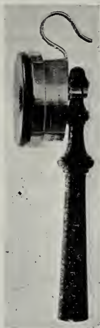
FIG. 16. — Récepteur Ducoussou à manche.
