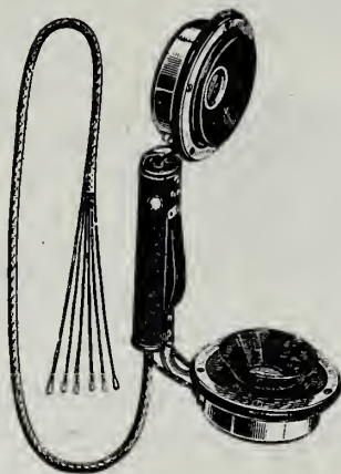
FIG. 98. — Appareil combiné Siemens et Halske avec bouton d'appel.
