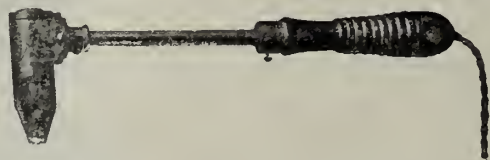
FIG. 45. — Fer à souder système Parvillée.
