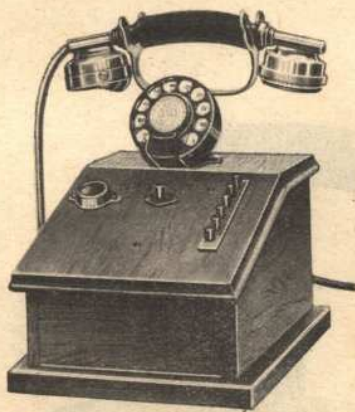
Poste mixte mobile 1 ligne État Automatique, 6 lignes privées
