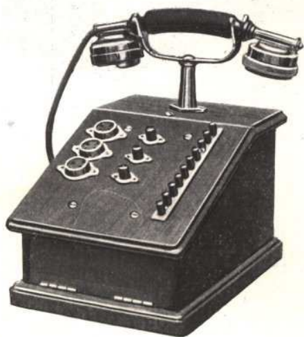
Poste mixte mobile à 3 lignes État B. C. I. et 10 lignes privées
