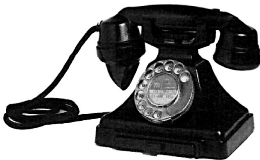
Teléfono automático en baquelita negra con disco giratorio de L.T.R. S.R.C., 1929-1933. Fuente: Romero Frías [1994, p. 232].
