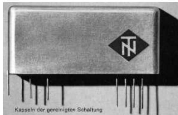
Zunächst waren es die mechanischen Steckverbindungen der Leiterplatten mit ihren Außen - Anschlüssen und die sogenannten Dickschichtschaltungen, die aus wirtschaftlichen und funktionellen Gründen in die TN - Fertigung zu übernehmen waren. Auch die Fertigung und die laufende Weiterentwicklung der Leiterplatten, von der einseitig kaschierten zur durchkontaktierten zweiseitigen Leiterplatte, stellten hohe Anforderungen an Entwicklung und Fabrikation.
