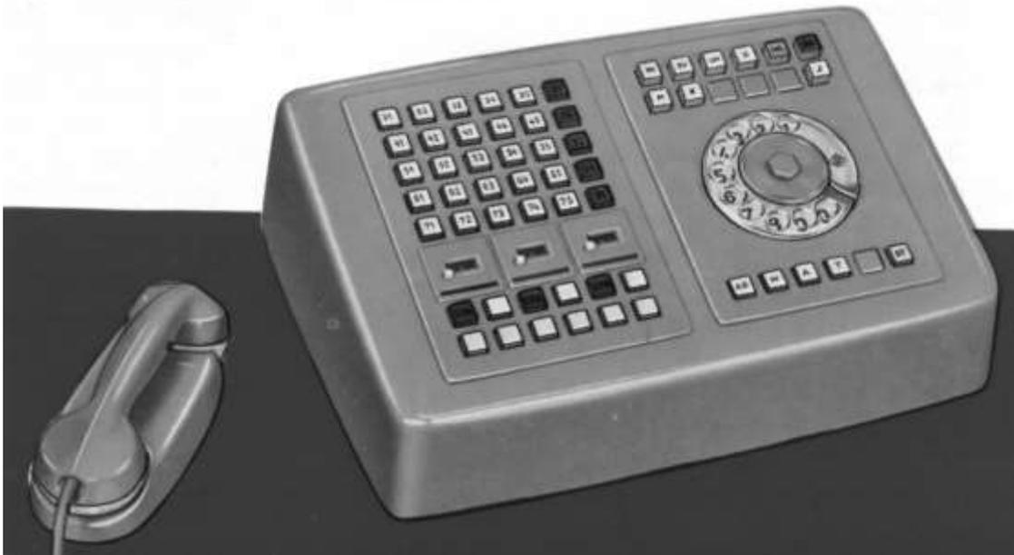
*Vermittlungsapparat der FSK Universal-Zentrale
