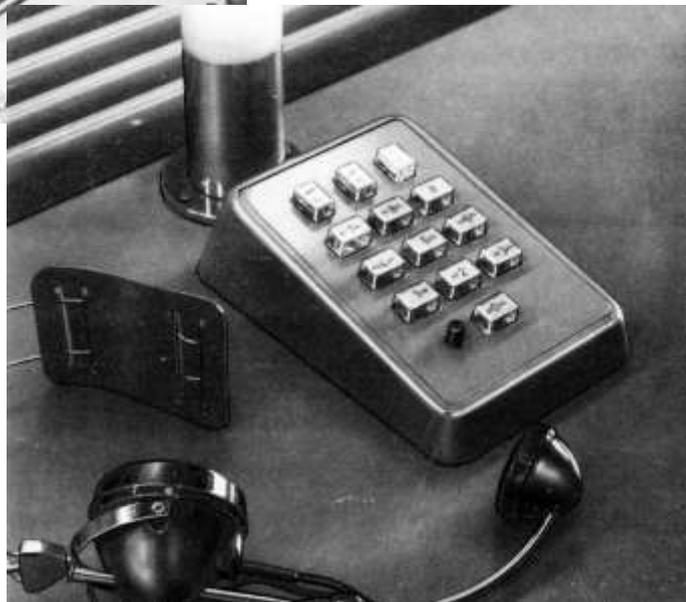
Von unten nach oben zählend sind die waagrecht angeordneten Tasten 0 bis 9 des Zahlengabers zu erkennen. Die Leuchttaste "Null" des Zahlengabers ist z.B. gleichzeitig für die optische Signalisierung der Anrufe sowohl vom Amt her als auch aus der Nebenstellenanlage zuständig; sie ist zugleich auch die Abfragetaste. Wie aus dem Bild zu erkennen ist, tragen alle Tasten - außer der "9" - zusätzliche Bezeichnungen, die in etwa die Zahl ihrer Funktionen erläutern.
