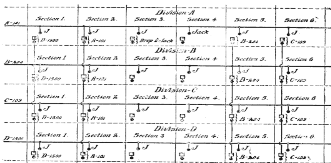
Fig. 82. — Disposition schématique d'un multiple divisé à 4 positions.
