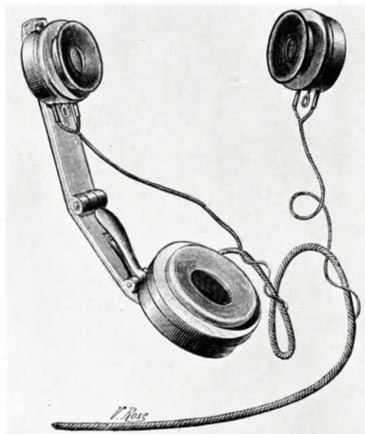
Abb. 148 Französisches Militär-Telefon, ist während des Transportes zusammenzuklappen. System Milde um 1892
