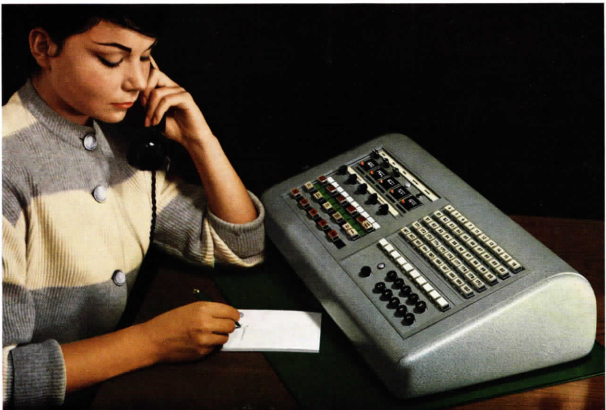
BILD 1 Vermittlungsapparat einer modernen Universalzentrale mit Leuchttastenzuteilung
