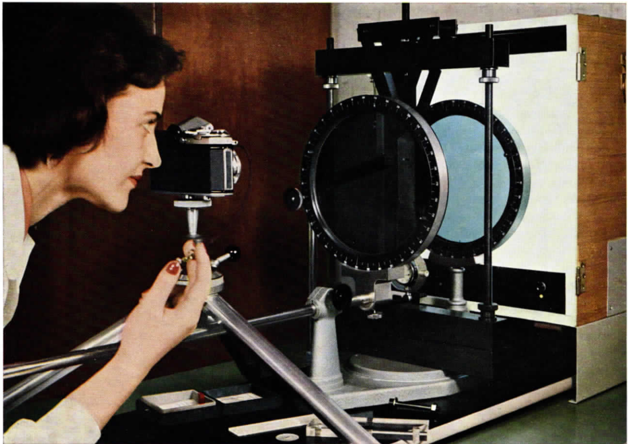
BILD 1 Polarisationsapparat. Von rechts nach links: Beleuchtungsgerät für weißes und Natrium-Licht, Polarisator, Belastungsrahmen mit eingespanntem Objekt, Analysator.
