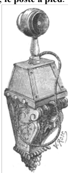
Poste de luxe sur console qui dissimule la pile.
