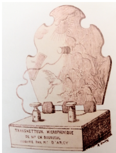
Transmetteur Bourseul adapté par d'Argy. Avec son micro miniature.
