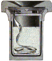
Fig 1 On constata que le papier offrait une résistance variable sous pression et, bien sûr, ne se tasserait pas. De plus, cette méthode n'était pas pratique, car elle devait être montée à plat pour maintenir l'eau dans le récipient.
