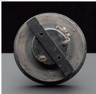
Émetteur à bouton de carbone Edison 1878
