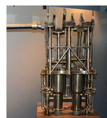
Moteur à vapeur Ader de 30 ch destiné au deuxième exemplaire « Zéphyr » de son avion. 37 kg nu mais 134 kg avec les accessoires.
