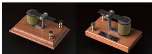
Reed téléphone (réplique), Bell's harmonic telegraph receiver
