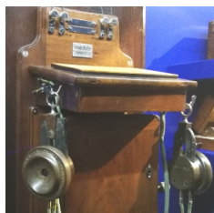
M.F; Heller à Nuremberg a aussi construit une station téléphonique simple destinée au service domestique.
