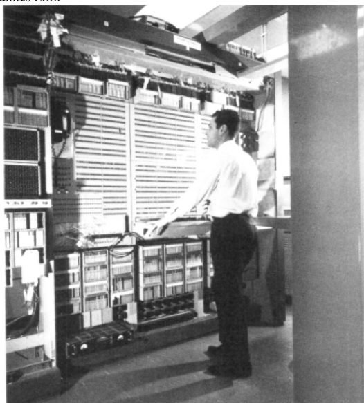
Figure 9-44. R. S. Cooper utilisant la console de test de programme ESS n°1, qui affichait l'exécution du programme ESS et aidait au débogage.
