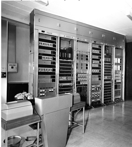
Commutateur PÉRICLÈS I Paris-Michelet, peu avant sa mise en service. Carte composant la Matrice de Connexion des Commutateurs PÉRICLÈS, réalisée à partir de 128 relais à tige et contacts scellés.
