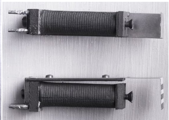
Indicateur visuel Ce drapeau indicateur aligne la section noire avec les fentes sur le panneau avant. Lorsqu'il est utilisé, la section blanche s'affiche.
