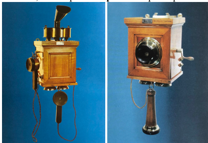
Poste téléphonique du type Boettcher électrodynamique avec 2 écouteurs (Musée POST Luxembourg) Poste téléphonique mural du type Boettcher avec microphone à charbon
