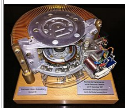
Sélecteurs EMD du dernier échange analogique allemand en 1997. Central 55v
