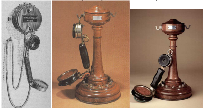
Transmetteur microphonique Steiner combiné avec applique vers 1894 (Microphone à grenaille)
