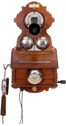
Le Téléphone Mix & Genest, Berlin. Modèle C2181, à microphone réglable avec pavillon, inducteur à manivelle en 3 parties, écouteur en forme de cuillère, cloche simple supplémentaire pour le commutateur Janus .
