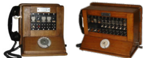
1938 Modèles de tableaux administratifs : 1+2 , 1+4 et 2+6 à clés, puis les 1+4, 2+6, 3+10 et 4+12 à jacks.
