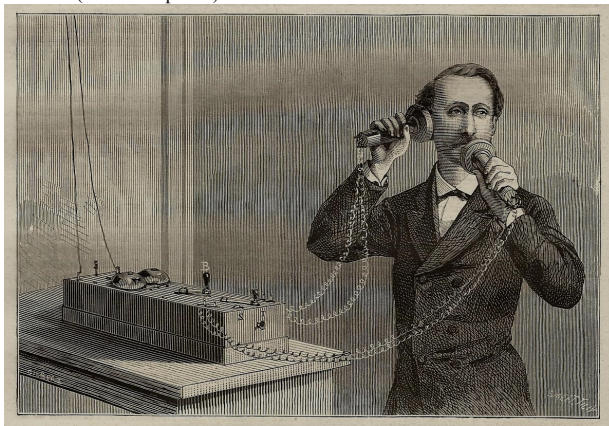
Disposition adoptée par M. Graham Bell pour l'usage du téléphone avec sa sonnerie magnéto-électrique. (D'après l'appareil fonctionnant à l'Administration des télégraphes.)
