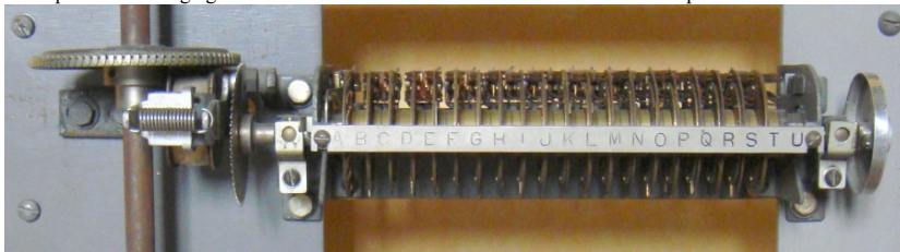
Combineur de Commutateur ROTARY 7A1 (Combineur de type 7011 à 21 galettes)
