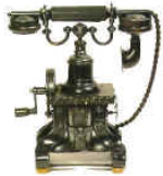
Le téléphone Ericsson, surnommé le "Skeleton", très répandu, était compatible sur les bureaux à batterie centrale.
