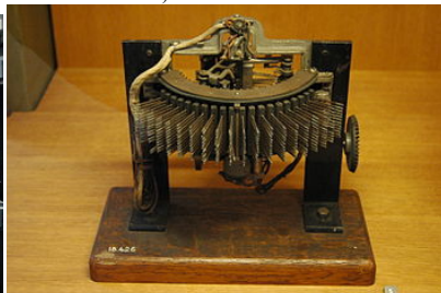
Chercheur de lignes (Partie fixe). — Chercheur de lignes (Partie tournante)
