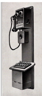
fig 1 L'un des premiers téléphones automatiques, montrant les boutons-poussoirs pour appeler.
