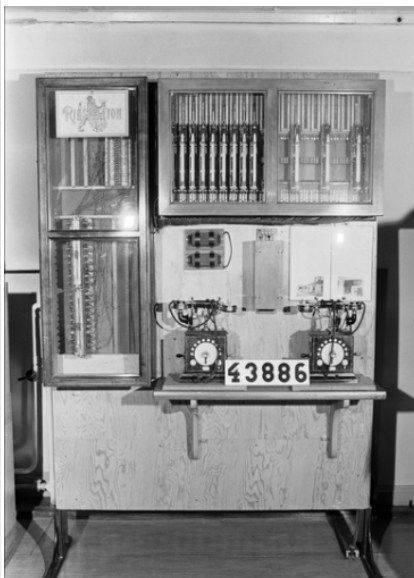
Photo des sélecteurs de montée Betulander, année 1900. Stand de Hultman avec registre et inverseur de série pour 2000 abonnés. (regardez les cadrans spéciaux des téléphones)
