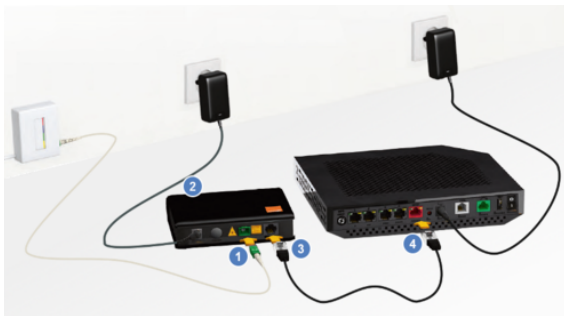
Branchement box à la fibre si le modem est extérieur (VDSL).
