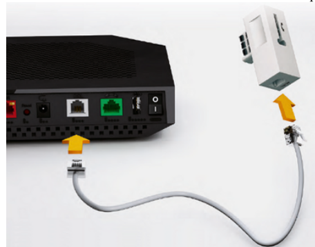
Branchement box port DSL à la prise murale T PTT (ADSL).
