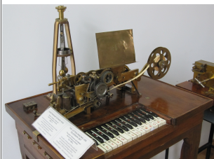
Hughes telegraph, un téléimprimeur précoce (1855) construit par Siemens et Halske
