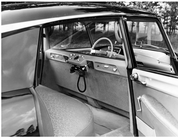
Poste avec combiné d'appel est du type PTT 1924 dans une Citroën DS19 - modèle 1956 équipés du Radiotéléphone Thomson-CSF R150 entièrement Manuel, d'une puissance d'émission de 10 watts.
