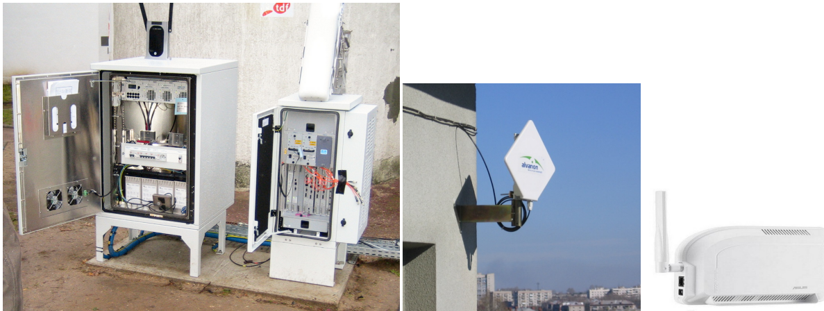
Station WiMAX, accès avec une antenne sectorielle ou un petit modem.
