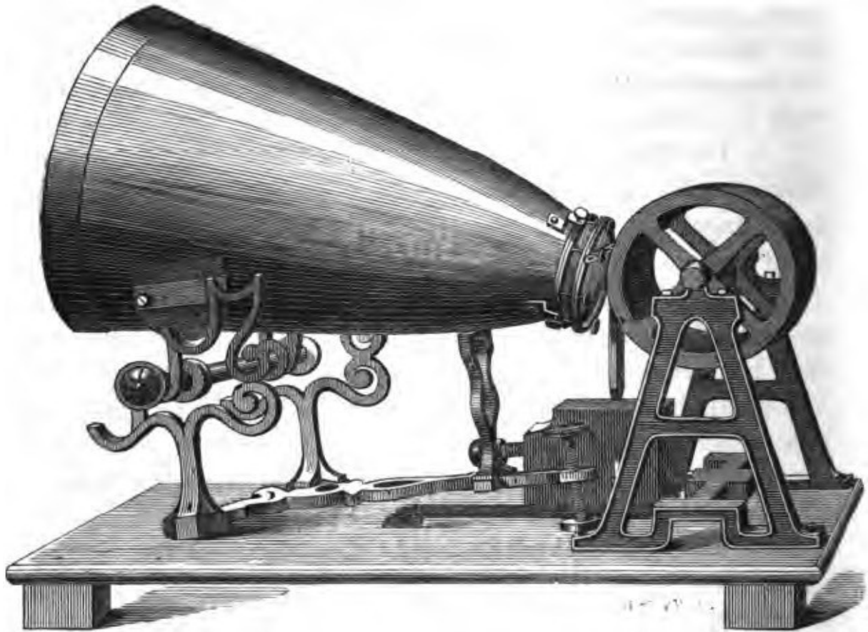
Second modèle du phonautographe (Koenig, circa 1861) – figure 23, dans Franz Josef Pisko, Die neueren Apparate der Akustik , Vienne, Gerold, 1865, p. 71-73 : « Phonautographe à membrane de Scott et König ».
