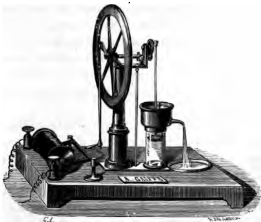
Fig. 56. — Pompe mue par l'électricité.
